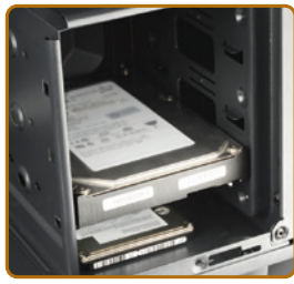
3.5" 硬碟磁架下方 預留一組2.5" 硬碟空間
