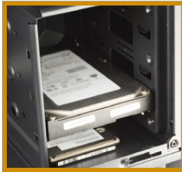
3.5" 硬碟磁架下方預留一組2.5" 硬碟空間
